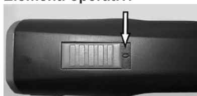
Fig. 4 Interruttore in posizione ferma ("0")
